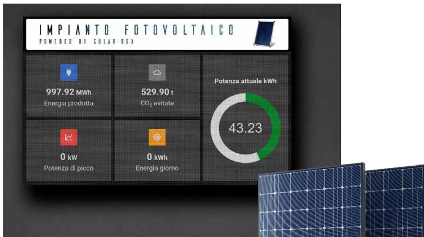
La visualizzazione dei dati monitorati è su richiesta del cliente: i dati visualizzabili sono fino a un **massimo di 8 campi per pagina** e sono dipendenti dalla scelta del passo. La comunicazione fra impianto fotovoltaico e display è mediata dall'analizzatore di rete e viene in un secondo momento elaborata dal processore.
